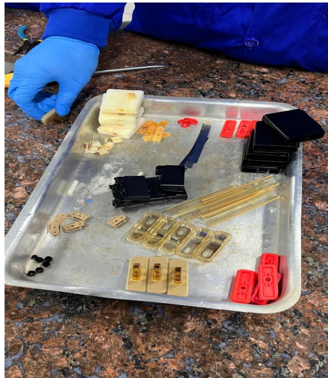
Figura 2: Desmontagem dos Cigarros Eletrônicos; Fonte: Dos Autores
